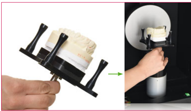
Abb. 11 Einscannen der Modellsituation in den virtuellen Artikulator über den Model Positioner Detector ...
